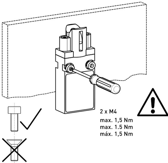
Schrauben gleichmäßig stufen- und wechselweise anziehen!
